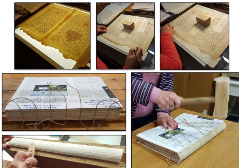
Fig. 4. Consolidarea la dublu a filelor, curățarea surplusului de material, recoaserea fasciculelor, rotunjirea cotorului, cașerarea cotorului cu hârtie japoneză.
