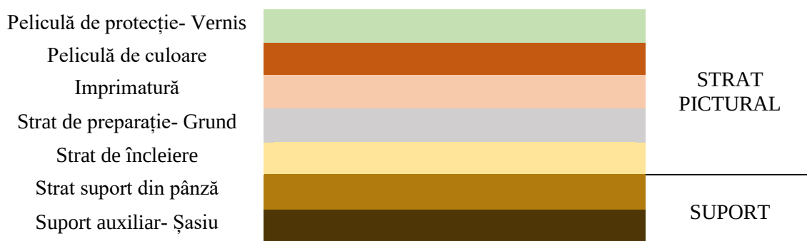
Fig. 3. Stratigrafie specifică picturii în ulei pe suport din pânză 2 .
