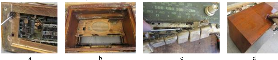
Fig. 2. Aspecte din timpul demontării (a, b și c) și a curățării umede (d).
