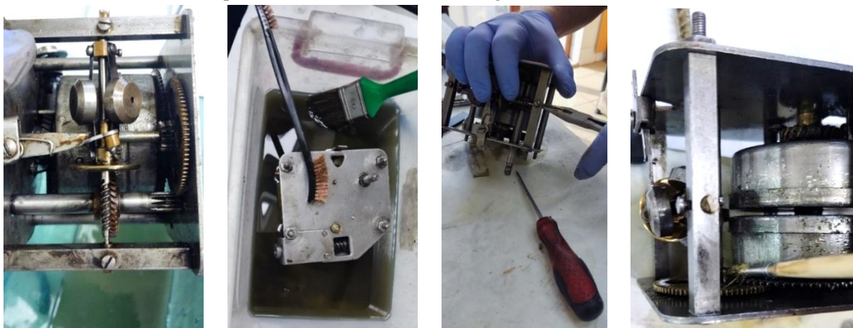
Fig. 8. Motor, deblocarea mecanismului prin imersarea în soluție de kerosen și acetonă, apoi angrenarea sistemului de blocare tip clichet-roată dințată a motorului, apoi gresarea tuturor componentelor motorului cu vaselină pentru mecanisme fine.
