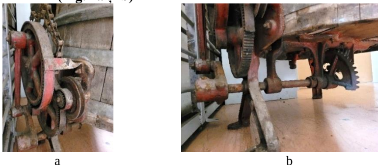
Fig. 2. Mașina de spălat MIELE: a și b - angrenajul mecanic, înainte de restaurare.
