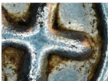
Fig. 5. Doza de redare. Coroziune acționare a mecanismului cu discuri. Uzură funcțională.
