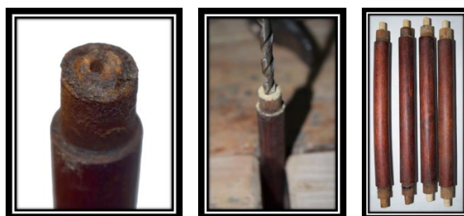
Fig. 8. Înlocuirea cepurilor rupte.
