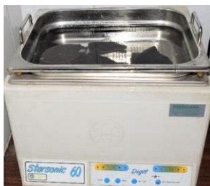
Fig. 9. Curățarea umedă: a - baia ultrasonică; b - curățarea mecanică cu ajutorul periilor moi.
