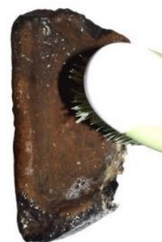
Fig. 9. Curățarea umedă: a - baia ultrasonică; b - curățarea mecanică cu ajutorul periilor moi.
